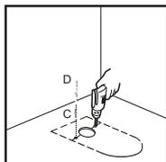
Perforar en las marcas realizadas y colocar los tarugos (C) y los pernos de fijación.
