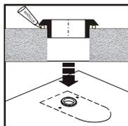
Colocar masilla plástica en el aro de acople y posicionar nuevamente el inodoro sobre el desagüe.
