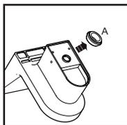
Voltear el inodoro hacia abajo y colocar el aro de acople (A) en la salida de descarga del inodoro e introducirlo en caño de descarga al piso (B).
