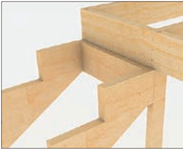
Fijar limones a la llegada del 2° piso.
