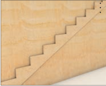
Fijar limones a la estructura.
