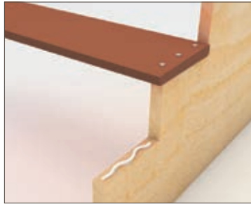
Fijar pieza de 2 x 4 y limones al piso.
